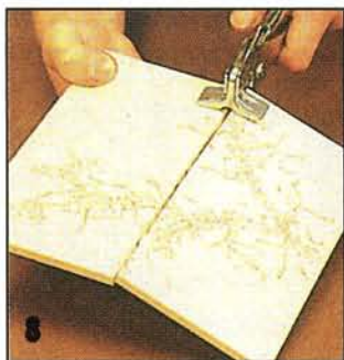
8 Для раскроя плиток применяют и комбинированный стеклорез с клещами.
